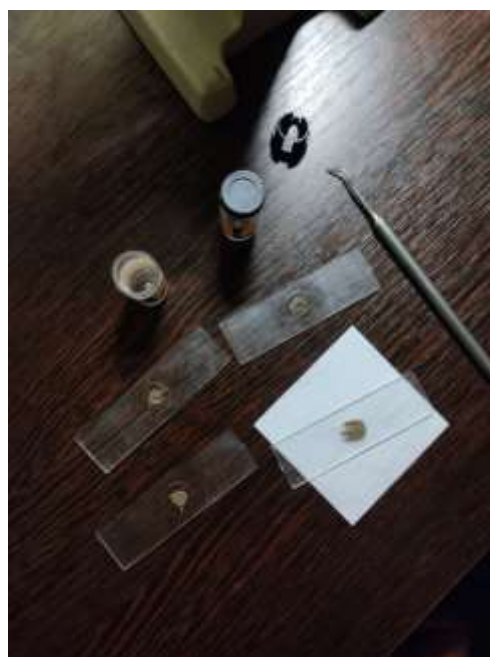
Рисунок 5 - Определение количества микропластика помощью микроскопа
